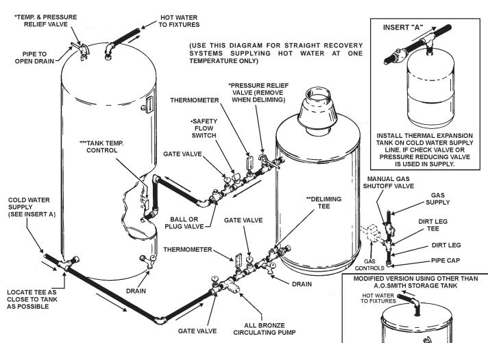
\*PIPE RELIEF VALVE TO OPEN DRAIN. INSTALL IN ACCORDANCE WITH LOCAL CODES.
